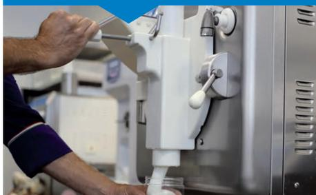
**Toutes les commandes restent accessibles** quand le couvercle est ouvert afin de permettre à l'opérateur de lancer les programmes.
